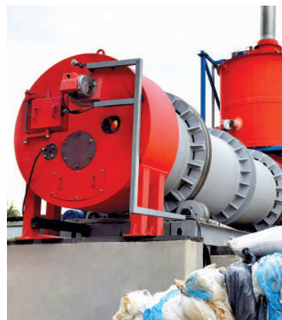
HURIKAN 1000 R - утилизация загрязненной пестицидами тары, неподлежащей переработке
